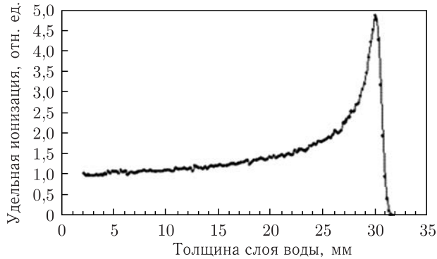
Рис. 15.2. Пик Брэгга при прохождении протонов с энергией 62 МэВ через воду
